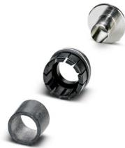
电缆夹紧弹簧和屏蔽夹适配器，屏蔽: 有，绞线束直径: 5.5 mm，电缆直径范围: 7.5 mm ... 9.5 mm，系列: NC，RC，备选产品符合RoHS II非豁免 6c (Pb < 0.1 %) 产品编号：1241807
