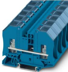
带螺栓连接和透明安全连接头的直通端子，接线容量：2.5 - 35 mm<sup>2</sup>，AWG：14 - 2，厚度：20.2 mm，颜色：蓝色
