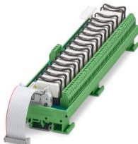
Varioface输出扩展模块，带16个可插拔微型电磁式继电器，每个1副转换触点，可用于24 V DC (带继电器)
