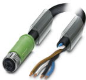
電源ケーブル, 4-極, PUR ハロゲンフリー, 黒-灰RAL 7021, 片側フリー, 上 ソケット ストレート M12 SPEEDCON, Tコーディング, ケーブル長: 5 m, 12 A/60 Vまでの直流電流
