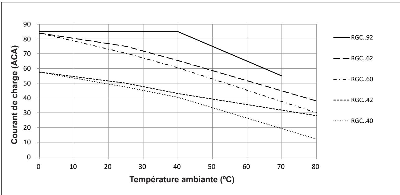
La température maximale de fonctionnement pour le modèle RGC...P est + 70°C / +158°F
