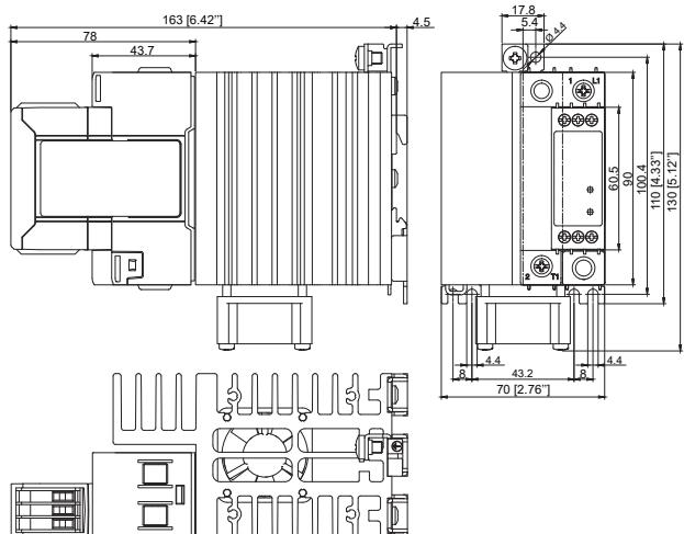
La tolérance de la largeur du logement doit être de +0.5 mm, -0mm...conformément à la norme DIN43880
