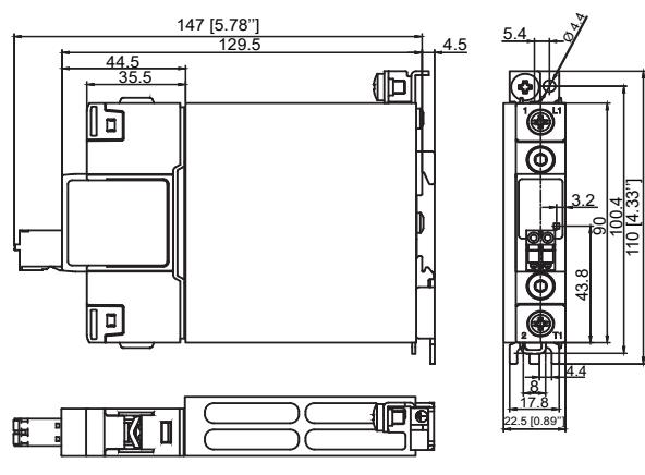
La tolérance de la largeur du logement doit être de +0.5 mm, -0mm...conformément à la norme DIN43880
