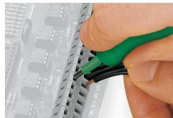
Raccordement des conducteurs avec un outil de manipulation (largeur de lame 3,5 mm)
