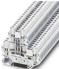
双层接线端子，标称工作电压: 500 V，额定电流: 24 A，接线方式: 螺钉连接，额定接线容量: 2.5 mm<sup>2</sup>, 横截面: 0.14 mm<sup>2</sup> - 4 mm<sup>2</sup>，安装方式: NS 35/7,5, NS 35/15，颜色: 白色
