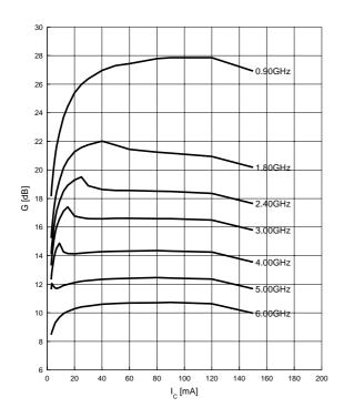
Power gain  $G_{ma}$ ,  $G_{ms} = f(V_{CE})$
