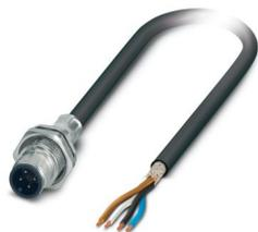
设备连接器 板后安装，通用，4-位置，PUR，黑-灰色 RAL 7021，屏蔽，针式插头，直头，M12-SPEEDCON，编码: A，与端自由出线，板后安装，M16 x 1.5，电缆连接，电缆长度: 1 m，无卤素PUR黑色，备选产品符合RoHS II非豁免 6c (Pb < 0.1 %) 产品编号: 1239252
