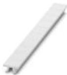
Tira Zack, Tiras, blanco, sin rotular, rotulable con: PLOTMARK, CMS-P1-PLOTTER, clase de montaje: encajar en ranura para índice alta, para ancho de borne: 10,2 mm, superficie útil: 10,5 x 10,15 mm
