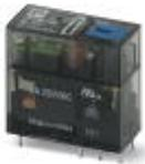
Relés miniatura enchufables, con contacto multicapa con capa de dorado duro, 2 contactos conmutados, tecla de comprobación, indicación mecánica de la posición de conmutación, LED de estado, diodo de libre circulación, polaridad A1+, A2-, tensión de entrada 24 V DC
