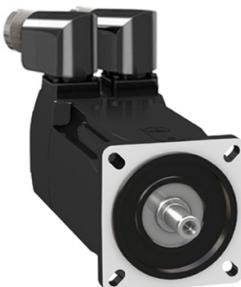
**Servomotor, Lexium BMH, 70mm, 3,4Nm, glatte Welle IP65, Multiturn 16P/U, 2xM23 abgewinkelt, Bremse**
