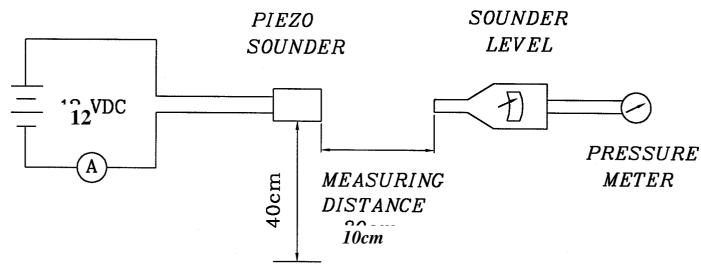
Mic : RION S.P.L meter UC30 or equivalent Mic : RION /UC30
