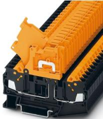
悬臂式分断接线端子，标称工作电压: 500 V，额定电流: 20 A，连接量: 2，接线方式: 快速连接，第一层，额定接线容量: 2.5 mm<sup>2</sup>，横截面: 0.5 mm<sup>2</sup> - 2.5 mm<sup>2</sup>，安装方式: NS 35/7.5, NS 35/15，颜色: 黑色/橙色
