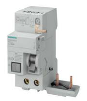
RC unit for 5SL4, 2-pole, type A, In: 40 A, 300 mA, Un AC: 230 V
