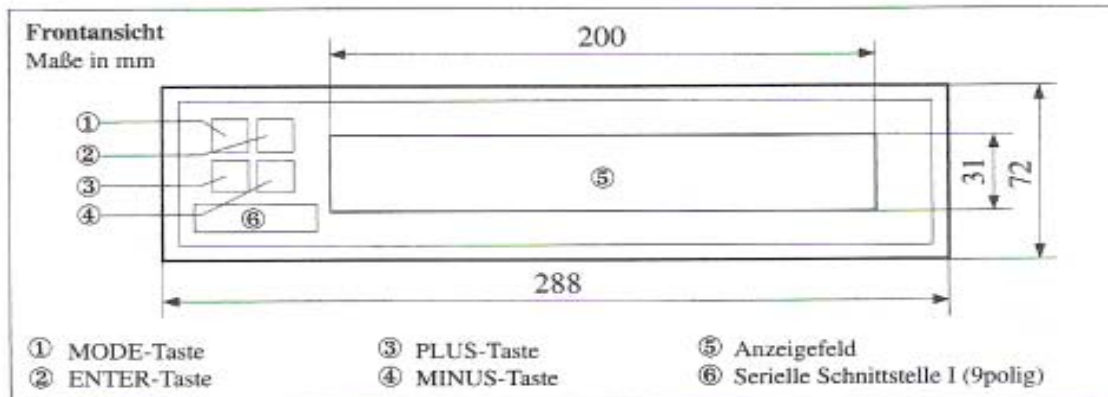
Bild D-5: Einbaumaße DAA 288-120/240, Frontansicht
