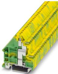
双层接线端子，连接量: 4，位数: 1，接线方式: 螺钉/插拔式连接，横截面: 0.2 mm<sup>2</sup> - 4 mm<sup>2</sup>，安装方式: NS 35/7,5，NS 35/15，NS 32，颜色: 黄绿相间
