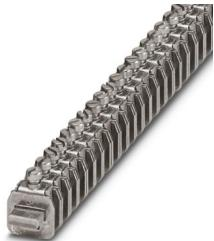
接线端子，接线方式: 螺钉连接，额定接线容量: 4 mm<sup>2</sup>，横截面: 0.5 mm<sup>2</sup> - 6 mm<sup>2</sup>，安装: 中性汇流条，颜色: 银色
