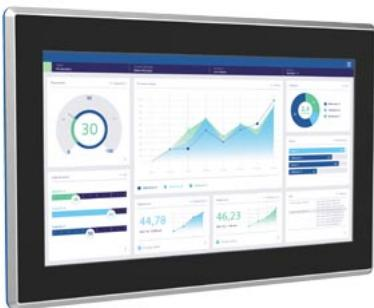
SIMATIC HMI MTP1500 Unified Comfort Panel Hygienic, Neutral Design IP69, Edelstahl, Hygienic Design, 15,6" Widescreen-TFT-Display, 16 Mio Farben, Touchbedienung, blaue FDA-konforme Dichtung, erhöhter Aufprallschutz mit Splitterschutz Displayfront entsprechend Richtlinien DIN EN 1672-2, FDA 21 CFR 177.2006, PROFINET Schnittstelle, projektierbar ab WinCC Unified Comfort V17, enthält Open Source SW, die unentgeltlich überlassen wird siehe beiliegende Blu-Ray
