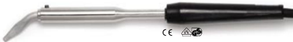
Die bewährten LötKolben der Serie **ERSA 50 / 80 / 150** sind ausgelegt für Lötarbeiten mit größerem Wärmebedarf, wie zum Beispiel an Kupferleitern mit Querschnitten von 2,5 mm<sup>2</sup> (ERSA 50, 50 W) bis 6 mm<sup>2</sup> (ERSA 150, 150 W).
