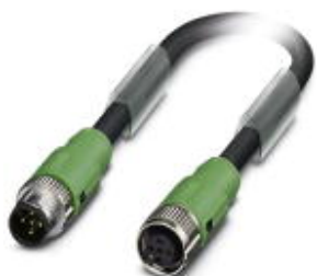
センサ/アクチュエータケーブル, 5-極, PUR, 黒-灰RAL 7021, プラグ ストレート M12 SPEEDCON, Aコーディング, 上 ソケット ストレート M12 SPEEDCON, Aコーディング, ケーブル長: 10 m
