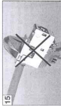
Wird die Zange zu weit hinten angesetzt, kann es passieren, dass das Ladestück verrutscht und die Schneidklammern im Inneren des Moduls beim Zusammendrücken beschädigt werden. If the pliers are placed too far back, the loader may slip slightly and consequently damage the ID contacts when the housing parts are pressed together.
