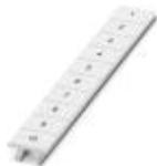
Nastro Zack, Striscia, bianco, siglato, siglabile con: CMS-P1-PLOTTER, siglatura trasversale: numeri progressivi 1 ...10, 11 ...20 ecc. fino a 91 ...100, tipo di montaggio: inserimento a scatto in scanalatura alta portacartellini, per morsetti con spessore: 8,2 mm, dimensioni campo di siglatura: 10,5 x 8,15 mm
