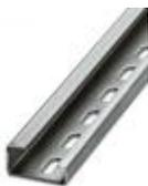
Guida di supporto forata, Profilo G, larghezza: 32 mm, altezza: 15 mm, a norma EN 60715, materiale: Acciaio, zincato, passivato a strato spesso, lunghezza: 2000 mm, colore: argento
