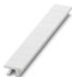
Nastro Zack, Striscia, bianco, in bianco, siglabile con: CMS-P1-PLOTTER, PLOTMARK, tipo di montaggio: inserimento a scatto in scanalatura alta portacartellini, per morsetti con spessore: 8,2 mm, dimensioni campo di siglatura: 10,5 x 8,15 mm
