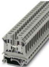
Morsetto passante, tensione nominale: 800 V, corrente nominale: 41 A, collegamento: Connessione a vite, numero di connessioni: 2, sezione: 0,2 mm<sup>2</sup> - 10 mm<sup>2</sup>, AWG: 24 - 8, larghezza: 8,2 mm, colore: grigio, tipo di montaggio: NS 35/7,5, NS 35/15, NS 32
