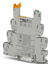
6,2 mm PLC-Grundklemme mit Schraubanschluss, ohne Relais- oder Solid-State-Relaisbestückung, zur Montage auf Tragschiene NS 35/7,5, 1 Wechsler, Eingangsspannung 230 V AC/DC
