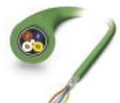
Câble de réseau, PROFINET CAT5 (100 Mbit/s), 4-pôles, PVC, vert RAL 6018, blindé, extrémité libre, sur extrémité libre, longueur de câble: 100 m
