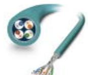
Câble de réseau, Ethernet CAT6<sub>A</sub> (10 Gbit/s), 8-pôles, PUR exempt d'halogène, bleu lagon RAL 5021, blindé, extrémité libre, sur extrémité libre, longueur de câble: Longueur au choix (0,5 ... 400 m)
