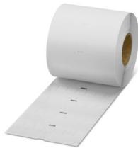
Wire-Wrap标签，盘卷，白色，未标记，适用的打印机：THERMOMARK E.300 (D)/600 (D)，THERMOMARK ROLL 2.0，THERMOMARK ROLL，THERMOMARK ROLL X1，THERMOMARK ROLLMASTER 300/600，THERMOMARK X1.2，电缆直径范围：4 ... 6.1 mm，安装方式：背胶固定，电缆直径：≤ 6.1 mm，标签数：15000，文本框高度：12.7 mm，文本框宽度：12.7 mm
