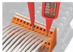
Tester par contact direct sur la surface de contact au-dessus du conducteur
