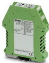
MCR電流測定用変換器、PC設定対応および設定可能、直流、交流、ひずみ電流を測定、リレーおよびトランジスタ出力を接続、入力電流0...10~0...50 A、未設定
