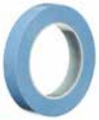
Le ruban de masquage Scotch® 2800 est spécialement conçu pour le masquage des surfaces en oléfine thermoplastique (TPO) et pour les cycles de cuisson pouvant atteindre 149 °C pendant 30 minutes. Il est compatible avec la plupart des peintures et des processus de peinture industriels et se retire proprement jusqu'à 7 jours à l'extérieur sans résidu, marque ou bavure.
