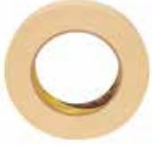
Le ruban de masquage 301E est un ruban papier crêpé épais pour les applications industrielles avec une bonne résistance à l'eau. Couleur chamois, adhésif caoutchouc, épaisseur 0,160 mm. Il peut-être exposé à des températures allant jusqu'à 100°C.
