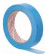
Le ruban de masquage 2899 est un ruban de masquage bleu couché sur un support fin lisse papier de riz et doté d'un adhésif acrylique, parfaitement adapté au masquage général pour peinture. Son épaisseur est de 0,081 mm et sa résistance à la traction est 30,7 N/cm. Il résiste à des températures de 150 °C pendant 1 h sur acier inoxydable.
