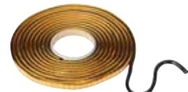
Le Mastic préformé Scotch-Seal™ R79 est un mastic toujours souple, à base de caoutchouc synthétique, sous forme de bande préformée. Il développe une excellente adhésion lorsqu'il est maintenu en compression.
