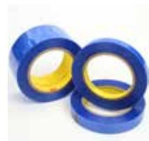
Le ruban 8902 possède un support polyester à haute résistance mécanique et un adhésif silicone pour être utilisé dans des applications sur substrats traités silicone composites ou pour des applications haute température (ex : masquage peinture poudre)
