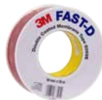
Le ruban 3M™ FAST-D est un ruban double-face imperméable à l'air, à l'humidité et à l'eau. Il possède une âme résistante et conforme et il adhère fortement sans primaire sur les surfaces difficiles à coller dans des conditions de températures variées.
