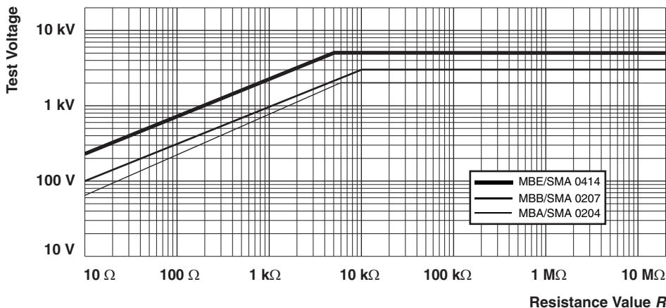
符合 IEC 60115-1, 4.27 规定的额定脉冲负载;  $1.2\mu s/50\mu s$ ; 5 个脉冲, 间隔为 12 秒
