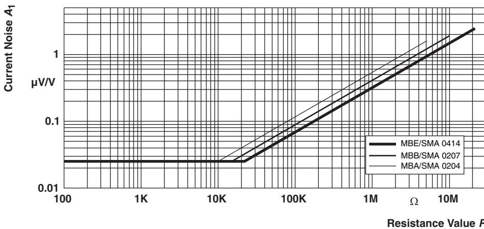
电流噪声 -  $a_1$  符合 IEC 60195 规定。
