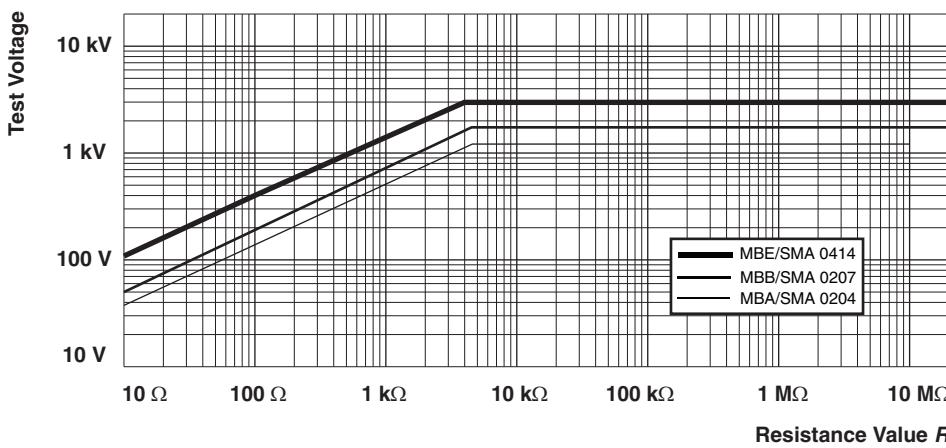
符合 IEC 60115-1, 4.27 规定的额定脉冲负载;  $10\mu s/700\mu s$ ; 10 个脉冲, 间隔为 1 分钟;
