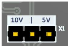
Fig.7. Puente de 10V | 5V
