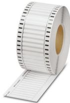
热缩管， 盘卷， 白色， 未标记， 适用的打印机：THERMOMARK E.300 (D)/600 (D) , THERMOMARK ROLLMMASTER 300/600 , THERMOMARK ROLL X1 , THERMOMARK ROLL , THERMOMARK ROLL 2.0 , THERMOMARK X1.2 , 电缆直径范围: 1.5 ... 3.2 mm , 未打孔 , 安装方式: 滑插式 , 标签数: 2500 , 文本框高度: 5 mm , 文本框宽度: 60 mm
