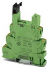
Morsetto base PLC da 14 mm senza equipaggiamento relè, per il montaggio su guide DIN NS 35/7,5, Connessione Push-in, 2 contatti di scambio, Tensione d'ingresso 24 V AC/DC
