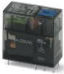
Relè in miniatura ad innesto, con contatto di potenza, 2 contatti di scambio, tasto di prova, segnalazione meccanica di stato, LED di stato, diodo di smorzamento, polarità A1+, A2-, tensione d'ingresso 24 V DC
