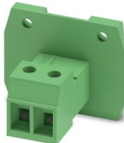
穿墙式连接器，额定横截面: 4 mm<sup>2</sup>，颜色: 绿色，额定电流: 20 A，额定电压(III/2): 630 V，触点表面: Sn，触点类型: 针式插头，电位数: 2，行数: 1，位数: 2，连接量: 2，产品系列: DFK-PC 4/-GF，针距: 7.62 mm，接线方式: 带压片的螺钉连接，螺钉头规格: L 开槽，安装: 直接安装，导线/PCB连接方向: 0°，每个电势的焊针数量: 1，插拔系统: COMBICON PC 4，针式连接器样式对齐: 标准，互锁: 螺钉锁紧，安装方式: 螺钉法兰，包装类型: 纸箱包装
