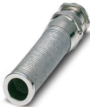
电缆密封，螺钉连接材料: 镀镍铜，应用: 标准，电缆外径 13 mm ... 21 mm，屏蔽: 无，连接螺纹: M32 x 1.5，颜色: 银色，带抗弯折保护套管，带O型圈
