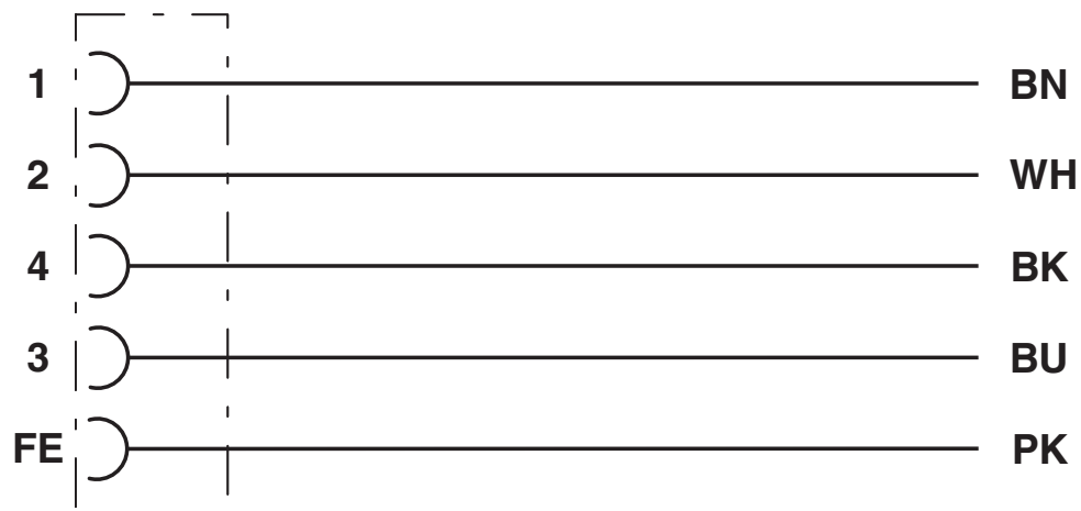
Kontaktbelegung der M12-Buchse
