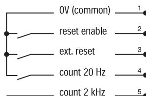
Version entrée hors tension, raccordement par bornes à visser
