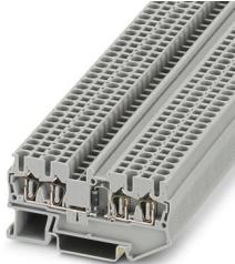
元件端子，带集成二极管1N 5408K，标称工作电压: 800 V，额定电流: 1.5 A，接线方式: 回拉式弹簧连接，额定接线容量: 2.5 mm<sup>2</sup>，接线容量: 0.08 mm<sup>2</sup> - 4 mm<sup>2</sup>，安装: NS 35/7,5，NS 35/15，颜色: 灰色
