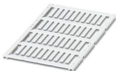
Leitermarker, Matte, weiß, unbeschriftet, beschriftbar mit: BLUEMARK E.CARD, BLUEMARK ID COLOR, BLUEMARK ID, BLUEMARK CLED, THERMOMARK PRIME 2.0, THERMOMARK PRIME, THERMOMARK CARD 2.0, THERMOMARK CARD, TOPMARK NEO, TOPMARK LASER, Kabeldurchmesserbereich: 0,6 ... 22 mm, Montageart: einschieben, Anzahl der Einzelschilder: 40, Textfeldhöhe: 4 mm, Textfeldbreite: 18 mm
