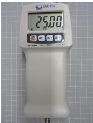
4. Mettere il peso corrispondente al gancio di carico. Tenere il dispositivo fermo senza tremare (suggerimento: tenere il dispositivo con entrambe le mani e appoggiare i gomiti su un tavolo o fissare su un qualche oggetto o banco di prova).
