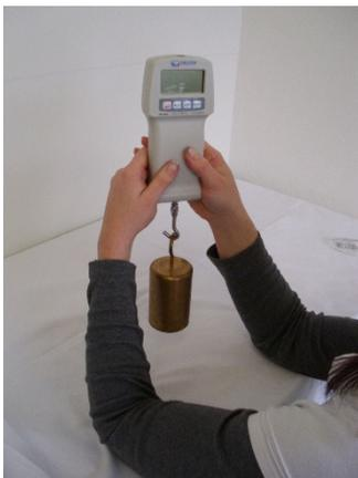
5. Mantenere questa posizione fino a quando sul display non appare "F". Dopo che rimuovere il peso e la calibrazione è completata. Nel caso in cui sul display appare "E" - ripetere il passo da 1 a 5 e quando sul display si visualizza "F" la calibrazione ha avuto un buon successo.
