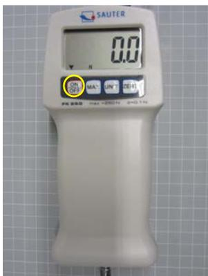
2. Quando sul display si visualizza zero, premere simultaneamente i tasti "UNIT" e "ZERO" fino a quando sul display non appare "CAL".
