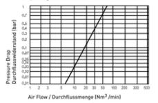
Hydraulic charts flow rate/Pressure drop Hydraulische Durchflusswiderstandkurve Pressure Drop Durchflusswiderstand (bar) 0.5 0.4 0.3 0.2
