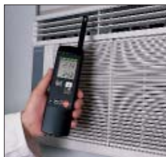
Messen der Austritts-Geschwindigkeit eines Klima-Gerätes
