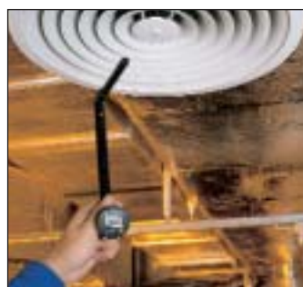
Strömungs-Messung z.B. an einem Lüftungsauslass
