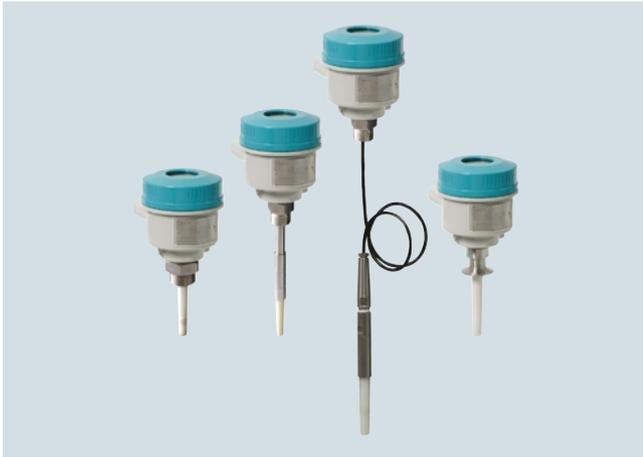
Pointek CLS200 (Digitalausführung) ist ein vielseitiger, kapazitiver Füllstandschalter mit Inverse-Frequency-Shift-Technologie. Er besitzt optionale Stab-/Seilsonden und einen konfigurierbaren Ausgang, ideal zur Erfassung von Flüssigkeiten, Schüttgütern, Schlämmen, Schaum und Trennschichten. Die Digitalausführung bietet PROFIBUS PA, eine LCD-Anzeige und erweiterte Diagnosefunktionen.
