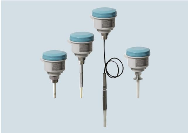
Pointek CLS200 (Standardausführung) ist ein vielseitiger, kapazitiver Füllstandschalter mit Inverse-Frequency-Shift-Technologie. Er besitzt optionale Stab-/Seilsonden und einen konfigurierbaren Ausgang, ideal für die Erfassung von Flüssigkeiten, Schüttgütern, Schlämmen, Schaum und Trennschichten.
