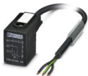
センサ/アクチュエータケーブル, 3-極, PUR ハロゲンフリー, 黒RAL 9005, 片側フリー, 上 バルブプラグ BI ( 11 mm ), ケーブル長: 10 m
