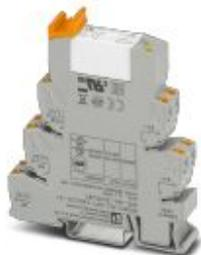
PLC-INTERFACE, composto da morsetto base PLC-BPT.../21-21 con connessione Push-in e relè in miniatura a innesto con contatto di potenza, per il montaggio su guida di supporto NS 35/7,5, 2 contatti di scambio, tens. di ingresso 24 V DC
