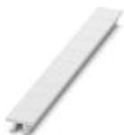
Nastro Zack, Striscia, bianco, in bianco, siglabile con: PLOTMARK, CMS-P1-PLOTTER, tipo di montaggio: inserimento a scatto in scanalatura alta portacartellini, per morsetti con spessore: 10,2 mm, dimensioni campo di siglatura: 10,5 x 10,15 mm, Numero dei cartellini singoli: 10
