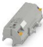
Adattatore V8 per 8 x PLC-INTERFACE (14 mm), controllo: Cablaggio di sistema PLC delle schede di uscita, collegamento 1: Connessione a vite 1x, collegamento 2: Connettore maschio IDC/FLK 1x 14-poli, collegamento 3: Attacco connettore (Può essere agganciato a scatto su 8 morsetti PLC-INTERFACE), numero di canali: 8, logica di comando: commutazione negativa
