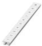
Nastro Zack, Striscia, bianco, siglato, siglabile con: CMS-P1-PLOTTER, siglatura longitudinale: numeri progressivi 1 ...10, 11 ...20 ecc. fino a 991 ...1000, tipo di montaggio: inserimento a scatto in scanalatura alta portacartellini, per morsetti con spessore: 10,2 mm, dimensioni campo di siglatura: 10,15 x 10,5 mm, Numero dei cartellini singoli: 10
