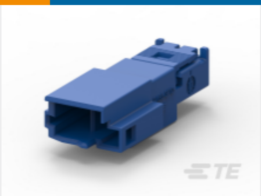
TE Part #2203701-2 2POS, MCON 1.2 CB TAB 2p TL UNSEALED
