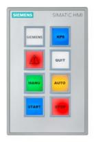
SIMATIC HMI KP8F PN, Key Panel, 8 Kurzhubtasten mit mehrfarbigen LED'S, PROFINET Schnittstellen mit PROFIsafe; 8 DE/DA und 2 Safety DE Pins, DC 24V durchschleifbar parametrierbar ab STEP 7 V5.5
