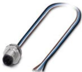
Conector enchufable de montaje incorp., Universal, 4-polos, Conector macho, recto, M12-SPEEDCON, codificado A, Montaje paredes delanteras, M16 x 1,5, Hilos trenzados individuales, longitud de cable: 0,5 m
