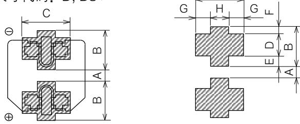
(推荐电路板焊盘尺寸)
