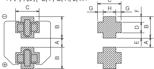
(推荐电路板焊盘尺寸)
