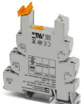
14 mm PLC-Grundklemme mit Schraubanschluss, ohne Relais- oder Solid-State-Relaisbestückung, zur Montage auf Tragschiene NS 35/7,5, 2 Wechsler, Eingangsspannung 24 V DC
