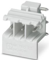
PCB插座，额定横截面: 2.5 mm<sup>2</sup>，颜色: 浅灰，额定电流: 16 A，额定电压(III/2): 320 V，触点表面: Sn，触点类型: 针式插头，行数: 1，位数: 3，产品系列: MSTBO 2,5/..-G1PR，针距: 5 mm，安装: 波峰焊，针脚排列: 直线排列，焊针[P]: 3.5 mm，每个电势的焊针数量: 1，插拔系统: COMBICON MSTB 2,5，针式连接器样式对齐: 垂直，互锁: 不带，包装类型: 纸箱包装，产品右侧带有针式插头输出
